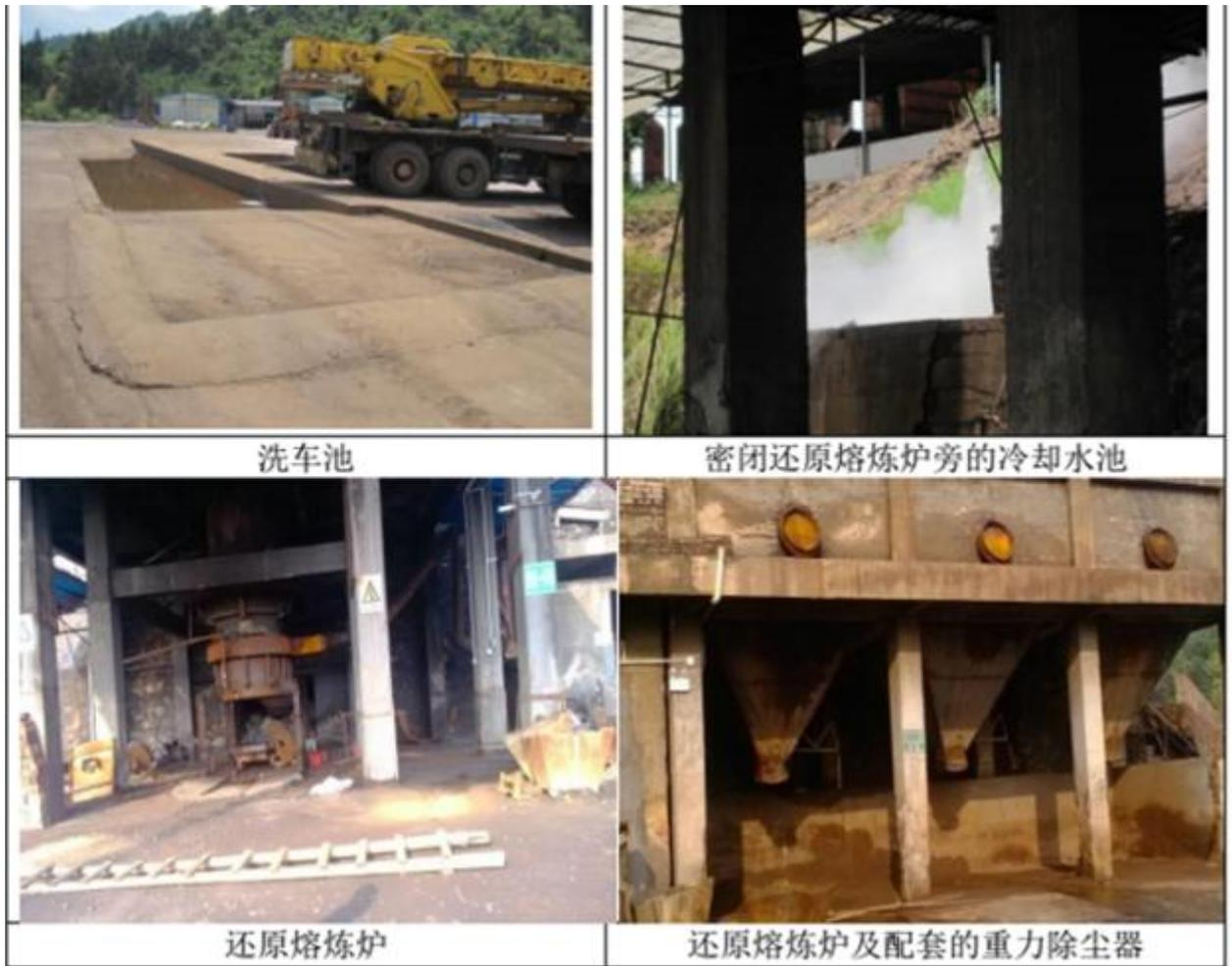
图 3-4 厂内部分生产设施图 1
